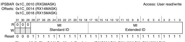
Figure 25-7. FlexCAN Rx Mask Registers (RXGMASK, RX14MASK, RX15MASK)
