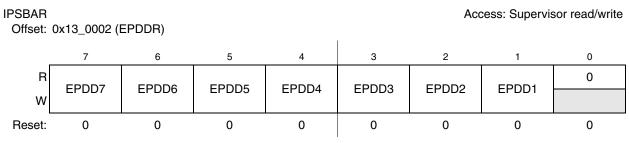
Figure 13-3. EPORT Data Direction Register (EPDDR)
