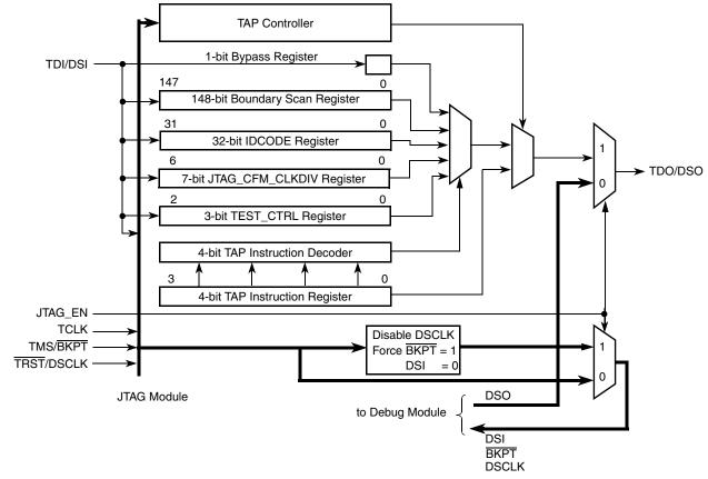
Figure 27-1. JTAG Block Diagram
